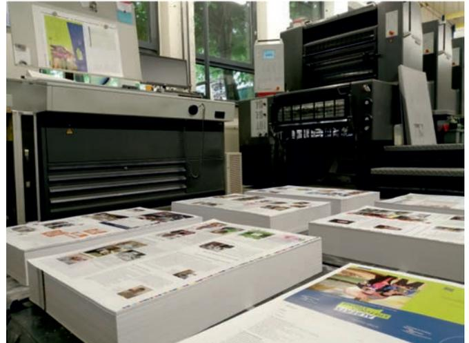
*Die entstandenen Einzelbögen werden zusammengetragen. So entsteht ein Block aller Seiten der fertigen Broschüre. Dieser wird mittig mit zwei Klammern geheftet und anschließend gefalzt. Nach einem sauberen Frontbeschnitt verlassen die fertigen Hefte die Maschine und können verpackt und verschickt werden.“*
